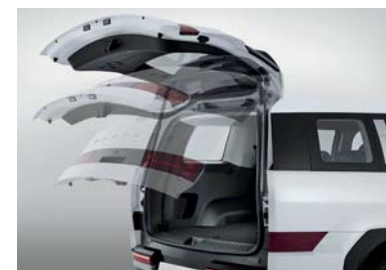
Chytré elektricky ovládané zadní výklopné dveře (s nastavitelnou výškou)
