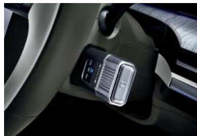
Řazení Shift by Wire (SBW) na sloupku řízení
