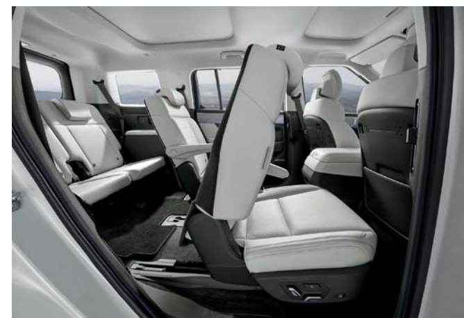
Kapitánská křesla s elektrickým sklápěním v 2. řadě (6místná verze) Jednoduchý přístup do 3. řady sedadel stisknutím tlačítka
